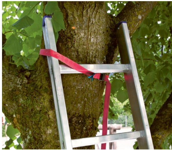
44 Gesichert mit Spanngurten
