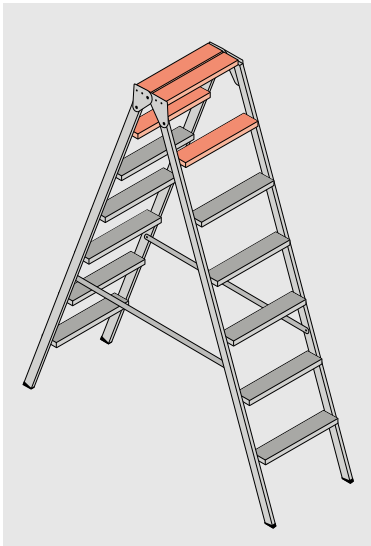
28 Die obersten zwei Stufen (Sprossen) einer herkömmlichen Bockleiter nicht benutzen.
