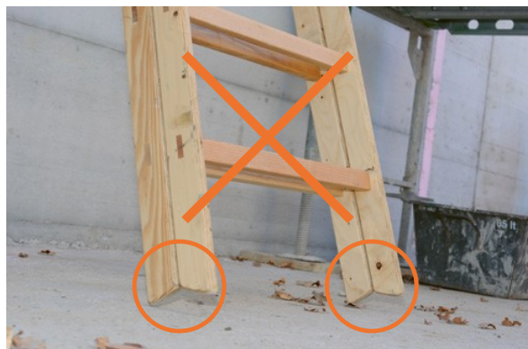
26 Wird die Stehleiter als Anstellleiter verwendet, steht sie nur auf der Kante der Leiterfüsse.
